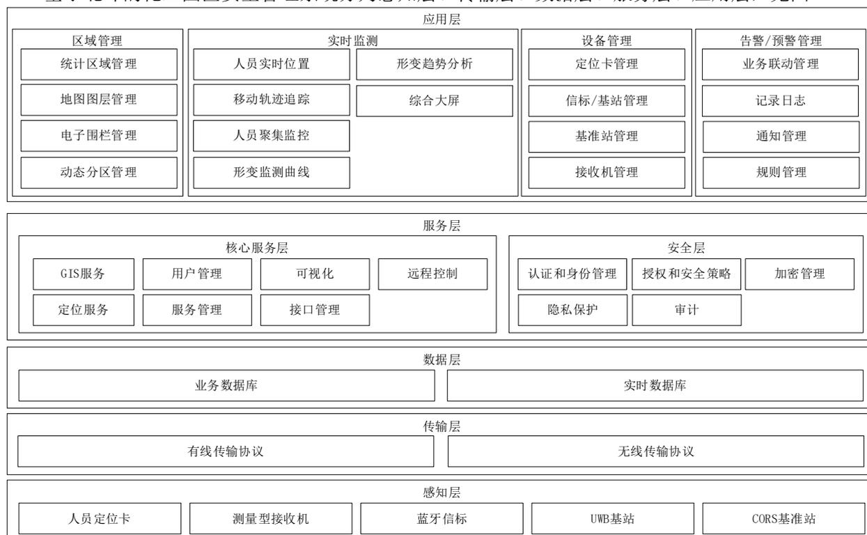
图1 基于北斗的化工园区安全管理系统架构
