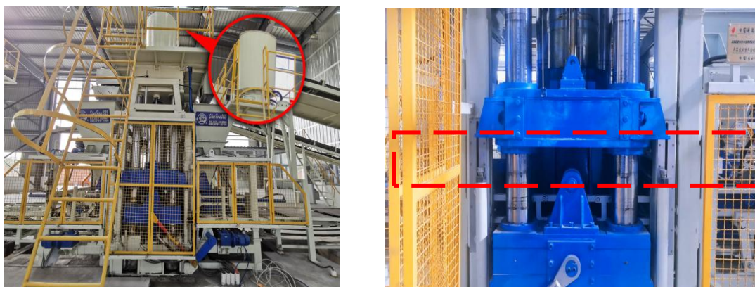
“压振一体、上压下振”制品成型新工艺及生产线装备
