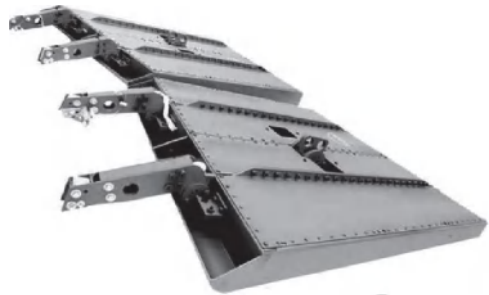
图 12-22 X-38 航天飞机中 C/SiC 复合材料应用示意图
