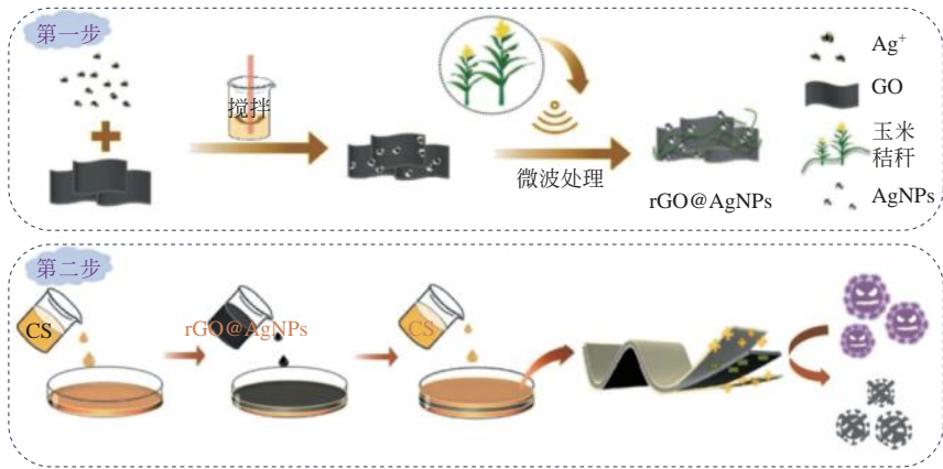
图 14-15 抗菌 CS/rGO@AgNPs 纳米复合膜的合成示意图 [40]
