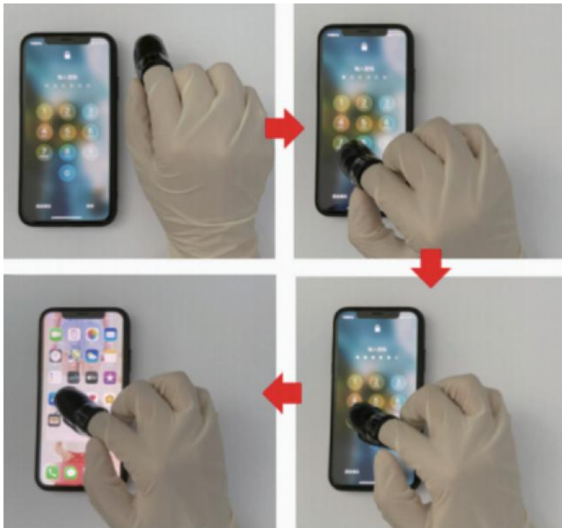
图 14-27 CMC/PDA 水凝胶模仿人类皮肤操控智能手机 [66]
