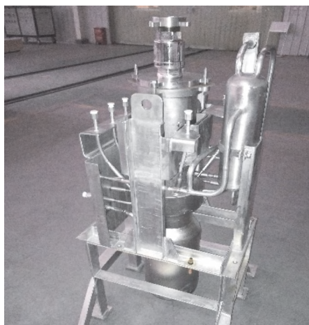
图 4-6 Ti35 合金溶解器
