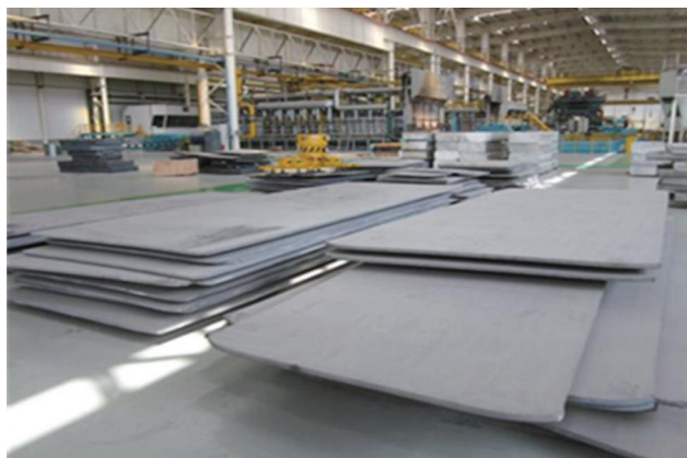
图 4-14 西部钛业公司制备的低成本高强度钛合金板材
