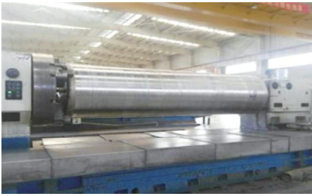
VAR熔炼（真空自耗电弧熔炼）， 成品锭直径1020mm
