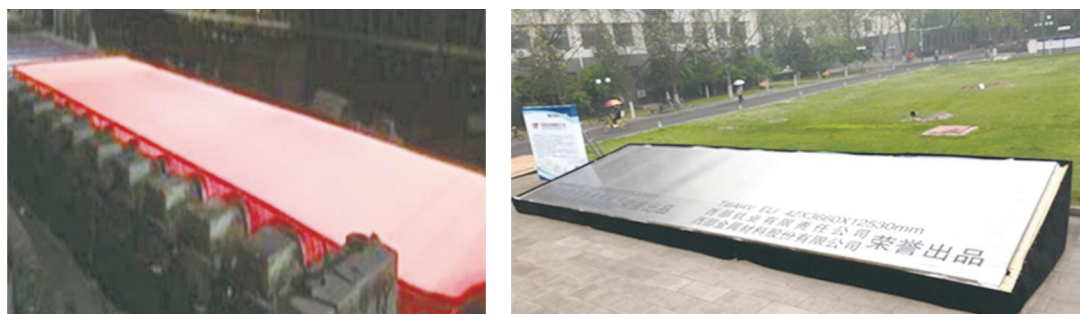
图 4-11 西部钛业公司制备的组织、性能合格的 TC4 钛合金厚板
