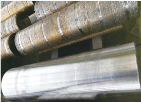
图 4-8 青海聚能钛业公司电子束冷床炉熔炼的 TA19 合金圆锭及不同部位化学成分
