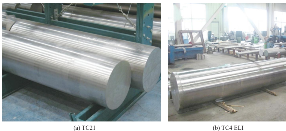
图 4-10 西部超导公司制备的直径为 350mm 的 TC21 合金棒材及直径为 650mm 的 TC4 ELI 棒材
