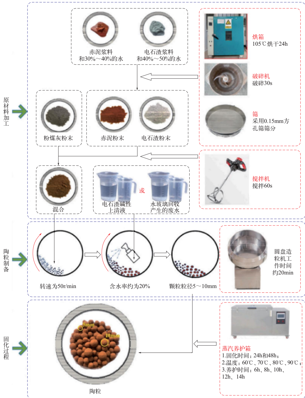
图 20-9 陶粒的原材料加工、陶粒制备及固化过程
