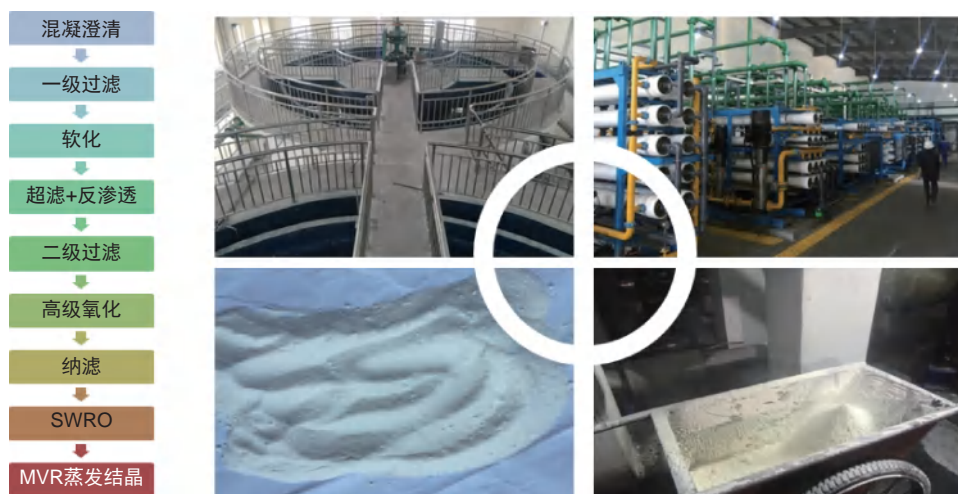
图 10-38 纳滤和多种膜技术耦合用于石化生产中高盐废水处理
