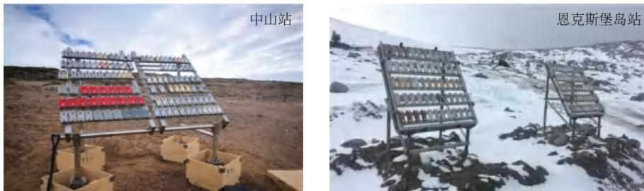
图 11-2 我国南极中山站及恩克斯堡岛站腐蚀暴晒场图片
