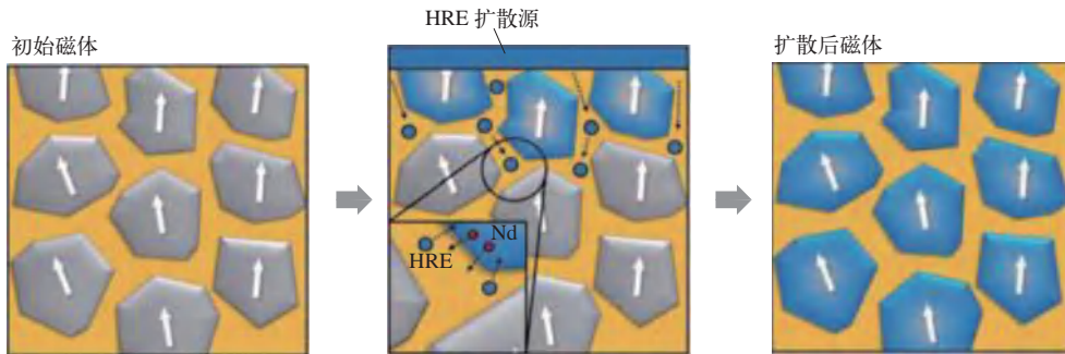
图4-1 重稀土的晶界扩散示意图(粗箭头代表磁畴取向,细箭头代表稀土原子扩散) [6]
