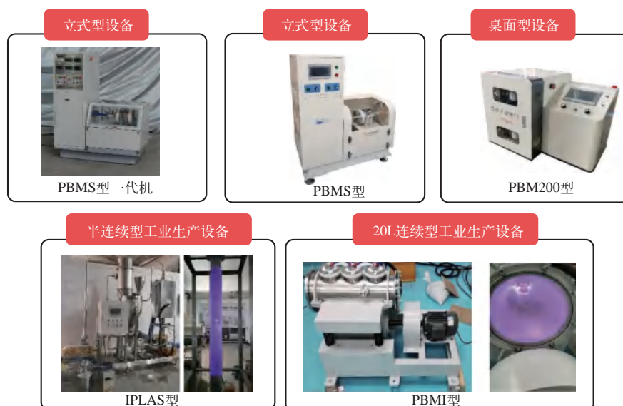
图 19-5 实验室级和工业生产级等离子球磨系列设备
