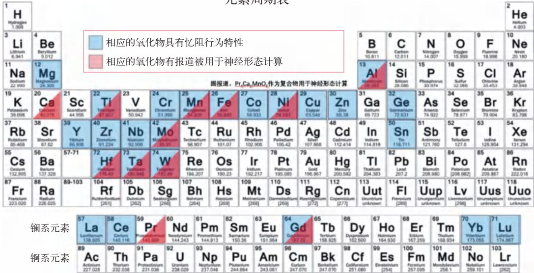
图 5-6 具有阻变特性的金属氧化物材料及在神经网络中的应用 [104]
